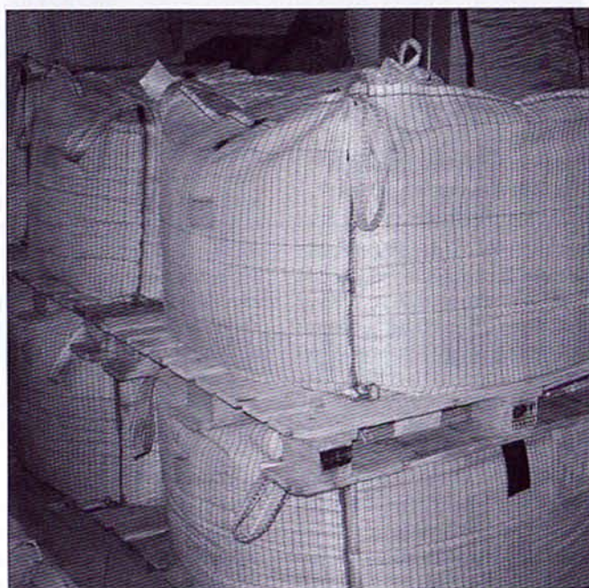
Das Altpulver wird üblicherweise in Bigbags angeliefert.
